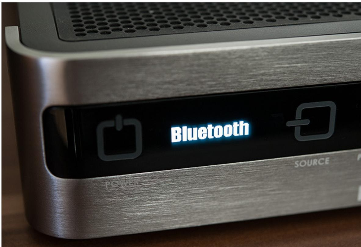
Setzt man den Element Verstärker in Betrieb, begrüßt einen das Display mit dem Firmenschriftzug. Das verbaute Display stellt hier eine kleine Besonderheit dar, denn ELAC setzt auf ein einzeliges OLED-Display, welches deutlich schärfer wahrgenommen wird als die üblichen LED-Anzeigen. Das sehr wertig wirkende Display informiert einen über den gewählten Eingang und die aktuell eingestellte Lautstärke.
